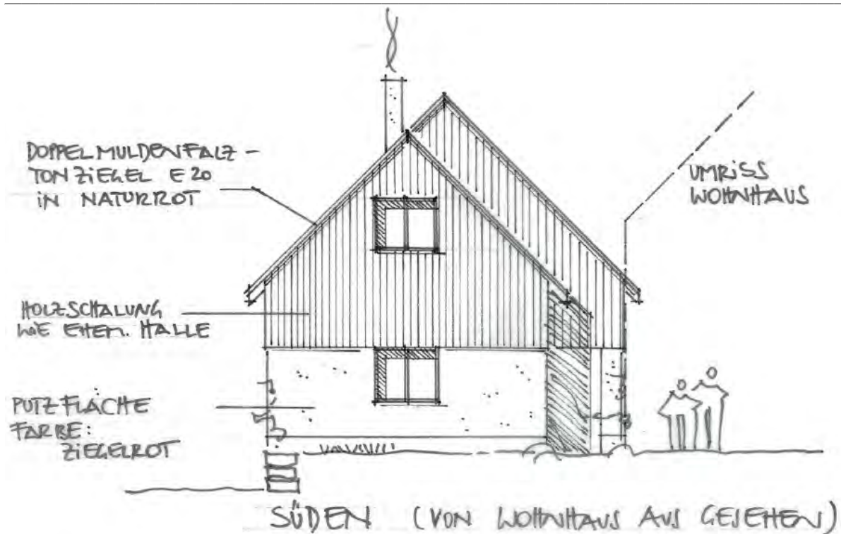
Bild 6: Ansicht Neubauhalle (Ersatzbau) Südseite
